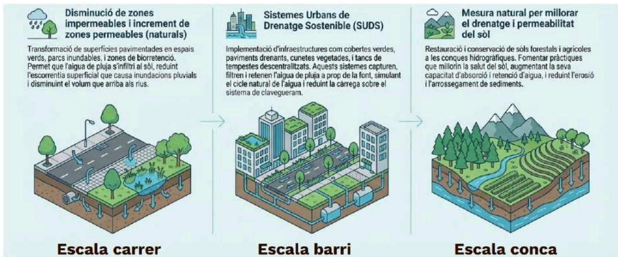
Figura 7. Mesures d'adaptació davant el risc d'inundació pluvial i fluvial. Font: AQUATEC (Veolia).
