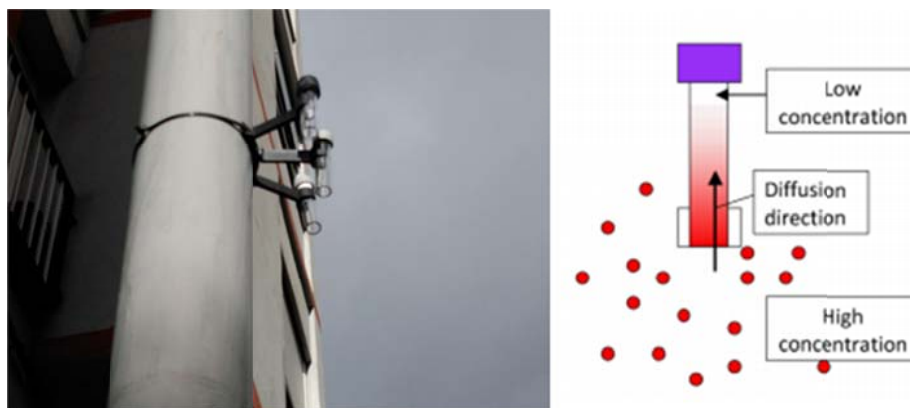
Figura 2: Dosímetros pasivos y principio de difusión de moléculas de \text{NO}_2 u \text{O}_3 .
